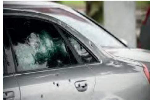
Los cristales curvos y planos fabricados por FC Group están compuestos por vidrio, Polivinil Butiral, policarbonato de alta calidad óptica, acrílico y poliuretano, combinados según la configuración solicitada por el cliente.
